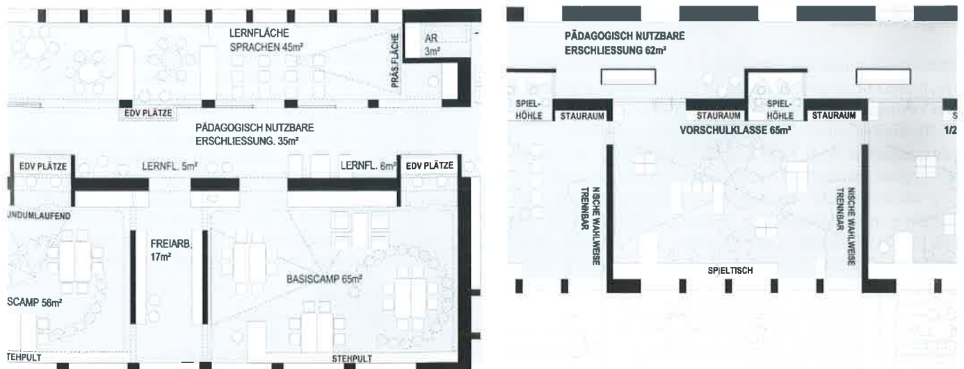
Bild 6. Links die NMS und rechts die VS – mit durchgesteckten Kojen und breiten Öffnungen atmet die Pädagogik durch die Mittelwand
